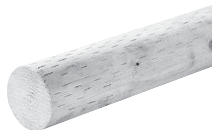
Bois rond perforé. La perforation améliore la profondeur d'imprégnation.
